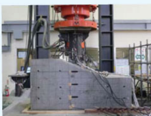
圧縮鋼管先端部の 耐力確認実験
