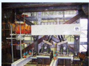
格点構造の静的載荷実験
