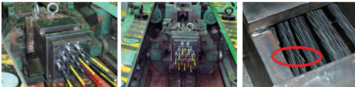
写真 4 緊張前 写真 5 緊張後 写真 6 緊張後 (PC 鋼材の定着偏向角 0°) (PC 鋼材の定着偏向角 7°) (破断状況)
