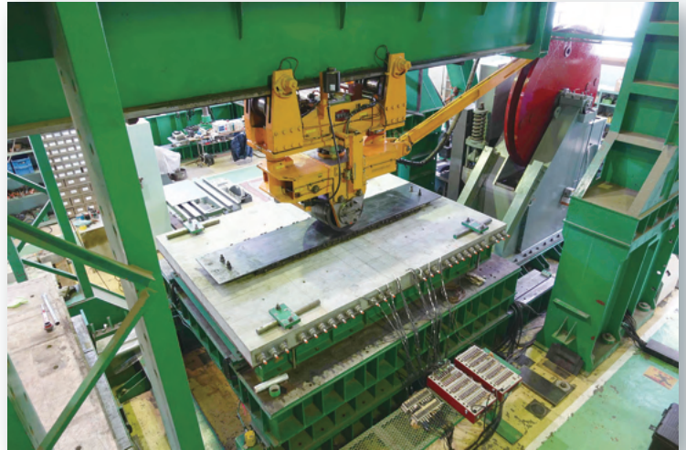
輪荷重走行試験の状況
