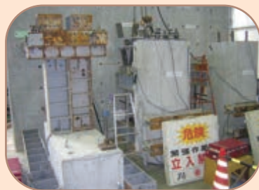
ピン接合部の水平加力実験
