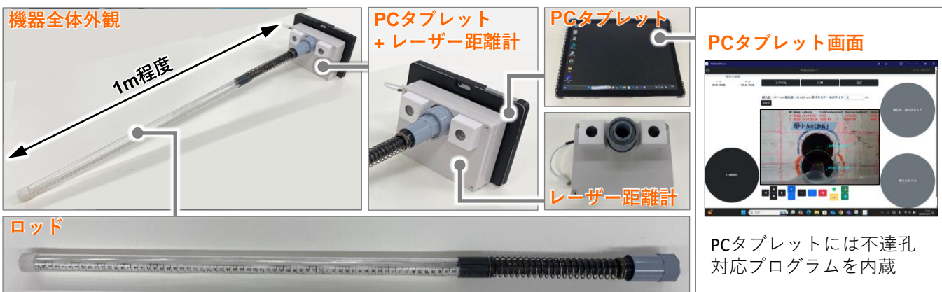
削孔管理IoTシステムの構成
