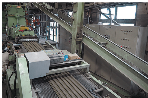
真空押出成形の製造ライン
